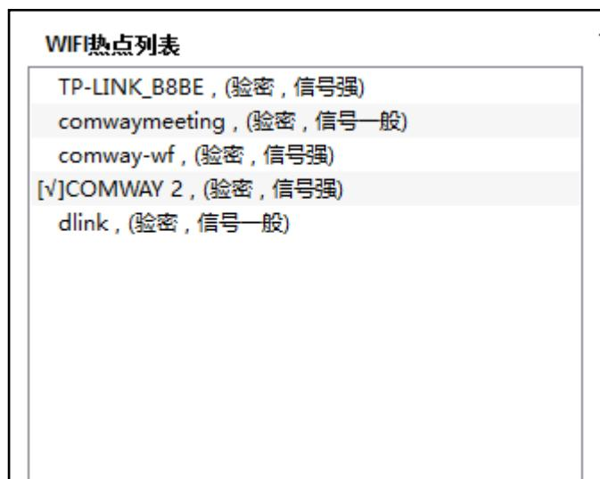
**手动设置 wifi 连接参数:** 用户可以直接输入热点名称和密码。若存在相同的 SSID, 则需手动输入 MAC 地址。
