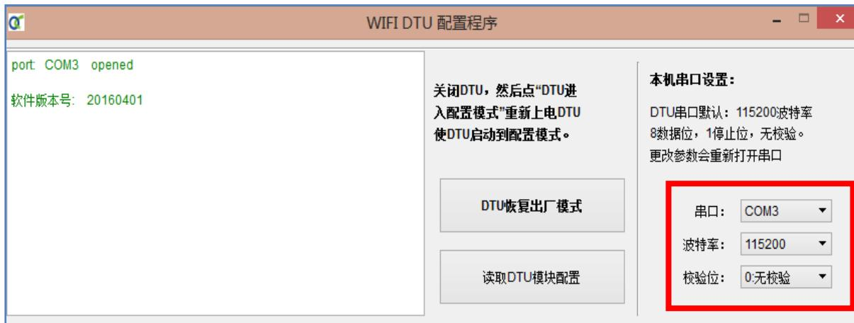
相应串口被正确打开，即显示如上图绿色字符：
